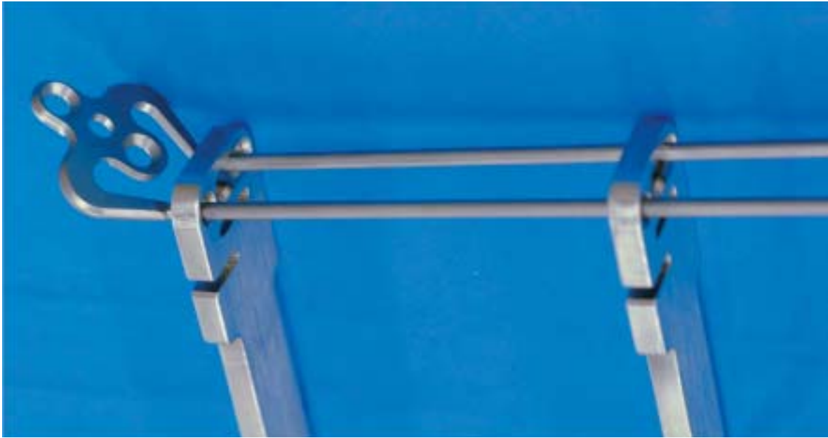
図3 専用ベンダー 2本のロッドを同時に曲げることが出来る
